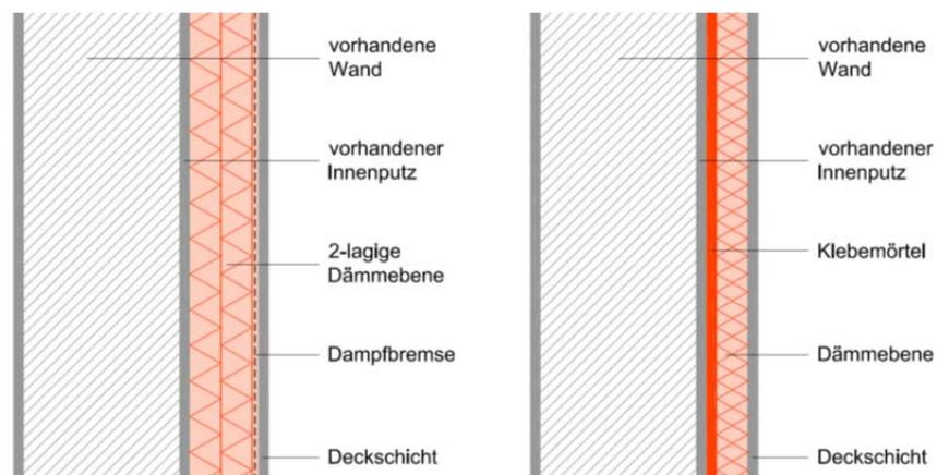
**Abbildung 4-13** Schematische Darstellungen von diffusionsoffenem (l.) und diffusionshemmendem (r.) Innendämmsystem
