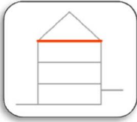
Bei unbeheizten Dachböden, die nicht zu einem späteren Zeitpunkt ausgebaut werden sollen, ist es sinnvoll, die erheblichen Wärmeverluste durch eine einfach zu realisierende Dämmung der obersten Geschossdecke zu reduzieren. Zudem ist laut §10 der EnEV eine Nachrüstverpflichtung festgeschrieben. Ab 1. Januar 2012 wird für begehbare, bisher ungedämmte Dachräume ein U-Wert von  $0,3 \text{ W/m}^2\text{K}$  gefordert.
